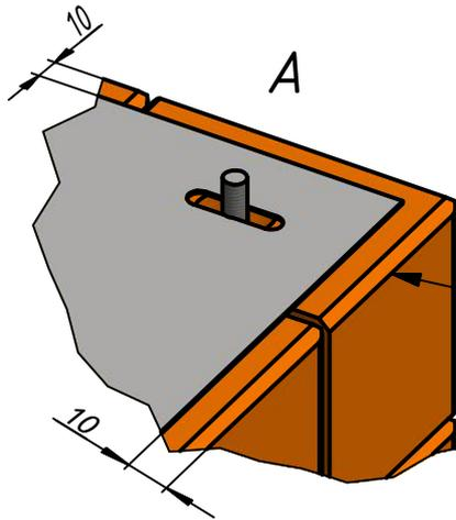
Расстояние между краями пластин и блоков около 10мм
