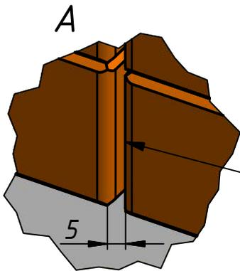
Между блоками мангала и тандыра зазор около 5мм
