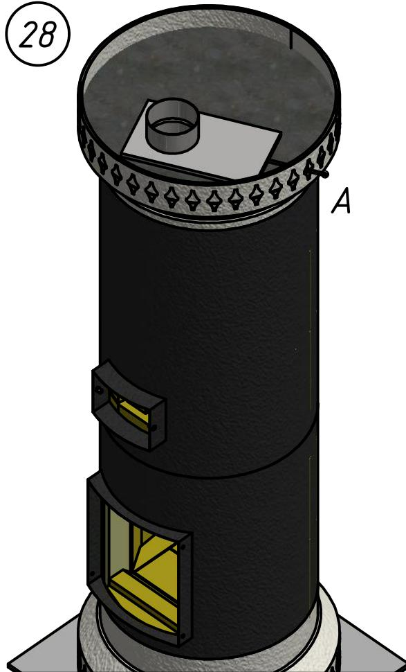
Далее следует примерить и отметить необходимую длину штока шибера м18. Шток должен выступать из верхнего фигурного обрамления корпуса м5 на 30...50мм в закрытом состоянии.
