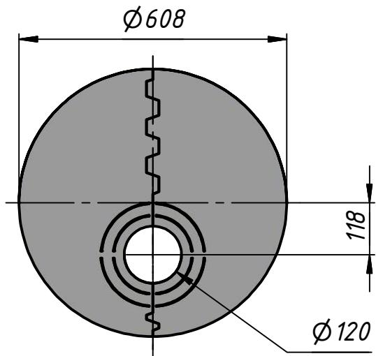
Разметку основания печи удобно произвести, положив на пол разъёмную крышку м9.
