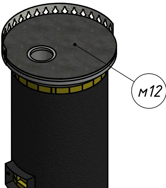
Уплотнитель Ч и рамку м11 прижать сверху деталью м12.
