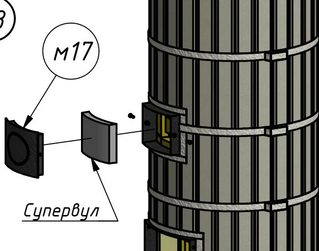
После сборки облицовки внутрь тоннеля прочистной дверки плотно вставить вырезанный с припуском прямоугольник из супервула, после чего установить заглушку чистки и закрепить ее болтами к1 – 2 шт.
