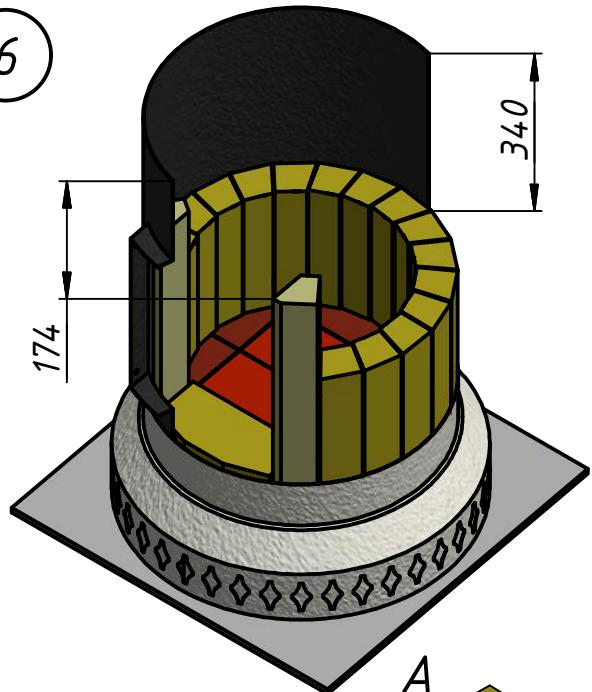
Для облегчения установки топочной дверки в конце процесса сборки, рекомендуется выполнять шаг 6, временно установив дверку на место. Толщина горизонтальных швов – около 4 мм, вертикальных – по месту.
