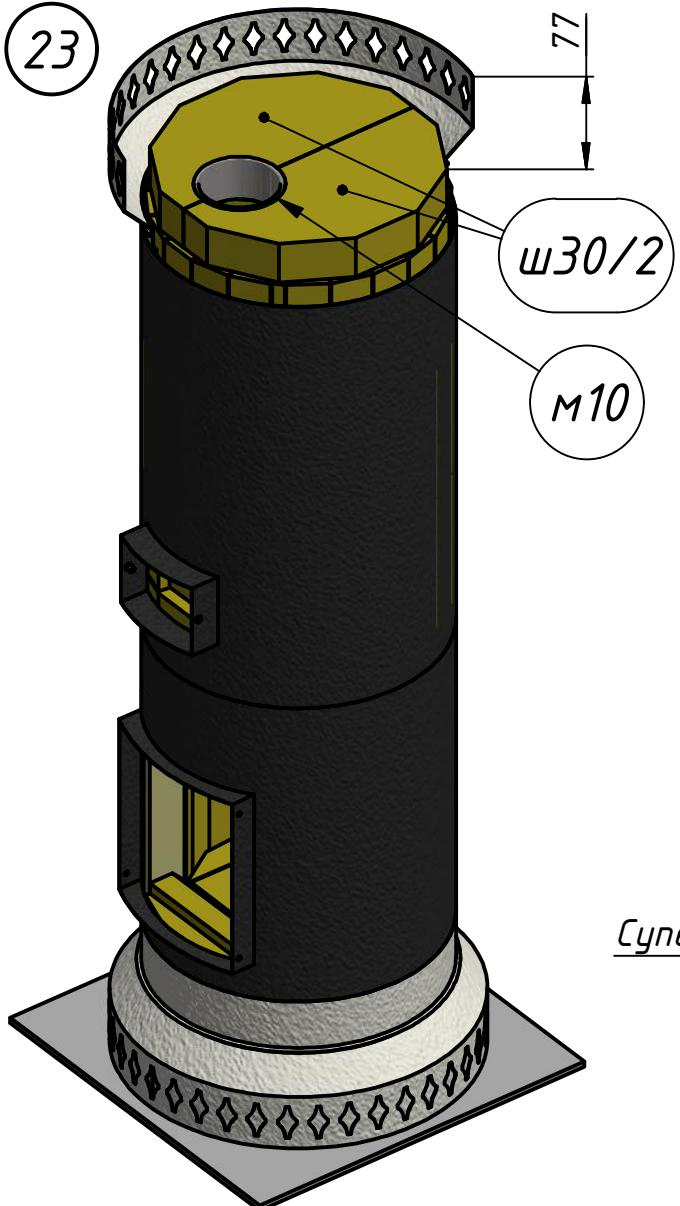
Угловой зазор между шамотом и деталью м4 проложить обрезками супервул и замазать раствором заподлицо с верхом шамота.
