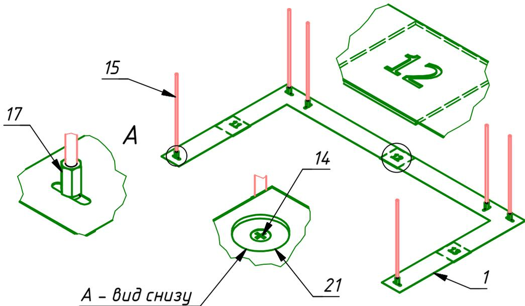
На пластине нижней 1 вырезаны места установки блоков 1 ряда. Блоки пронумерованы по часовой стрелке, начиная с левого переднего. 1 цифра - номер ряда, 2 цифра - номер блока в ряду. Буквы МО - мойка.
