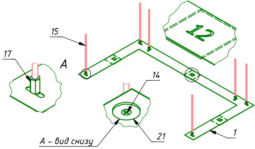
На пластине нижней 1 вырезаны места установки блоков 1 ряда. Блоки пронумерованы по часовой стрелке, начиная с левого переднего. 1 цифра - номер ряда, 2 цифра - номер блока в ряду. Буква С - стол.
