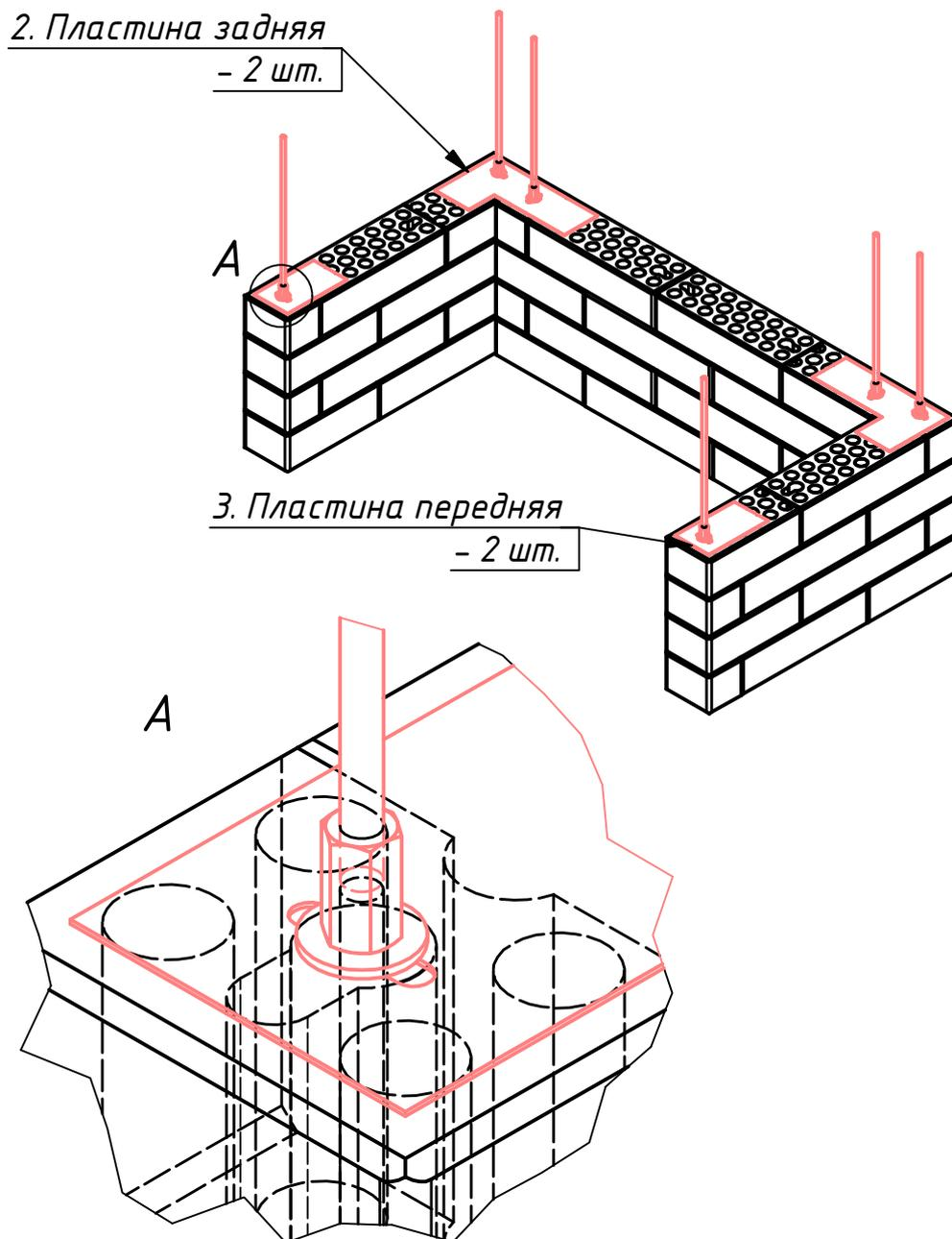
*Приклеиваем на герметик пластины второго ряда с одинаковым отступом от краёв блоков.*
