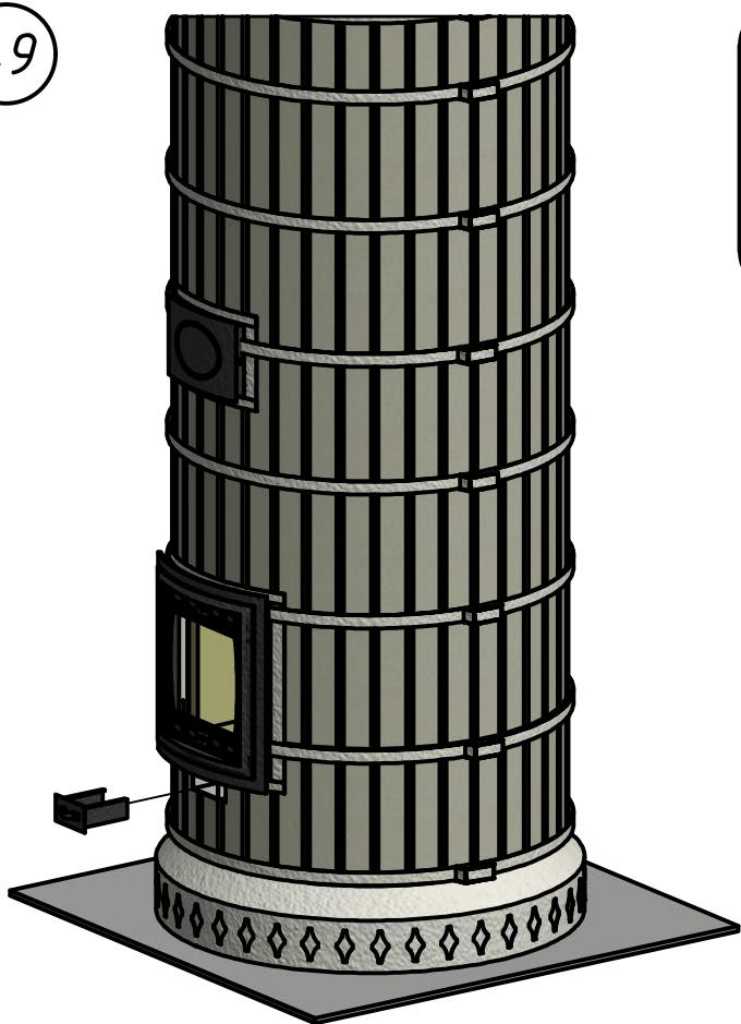
В заключение, установить на место регулятор притока *m10* и, при необходимости, увеличить отверстие под дымоход в верхней крышке *m6* до нужного диаметра.
