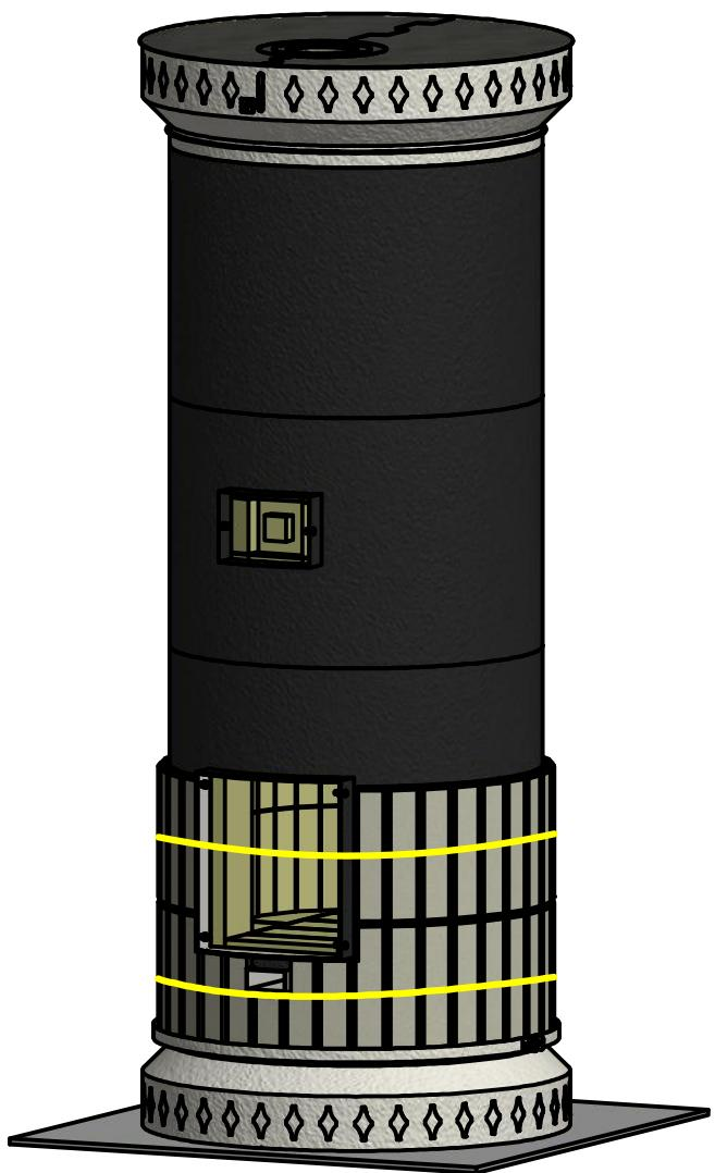
По мере сборки, эластичные жгуты необходимо передвигать вверх для установки следующего ряда плиток облицовки, предварительно зафиксировав предыдущий ряд при помощи хомутов. Замки хомутов рекомендуется располагать друг над другом.
