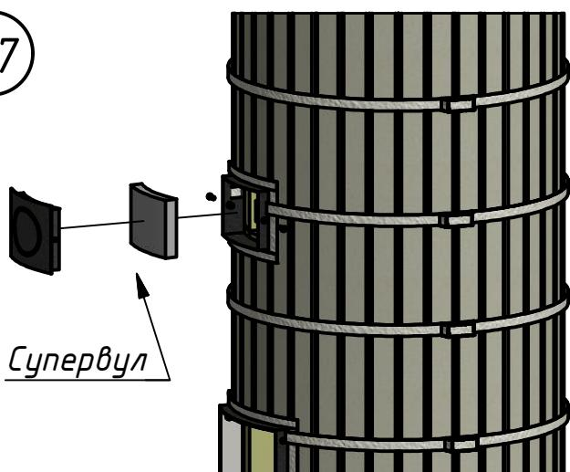
После сборки облицовки внутрь тоннеля прочностной дверки плотно вставить вырезанный с припуском прямоугольник из супервула, после чего установить заглушку чистки и закрепить ее болтами к1 – 2 шт.
