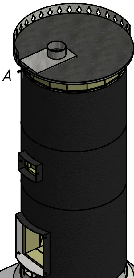
Далее следует примерить и отметить необходимую длину штока шибера м18. Шток должен выступать из верхнего фигурного обрамления корпуса м5 на 30..50мм в закрытом состоянии. Обрезать по отметке шток шибера, снять фаску и сделать пропил на половину диаметра в 4-х мм от края. Установить шибер на место расширенным патрубком вверх.
