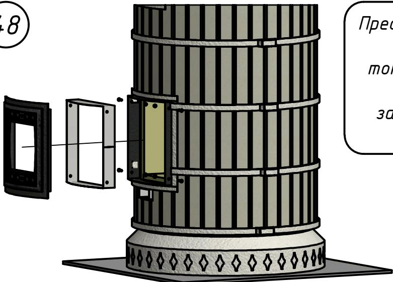
Предварительно открепив защиту тоннеля *m11*, установить топочную дверку *m23* и, вместе с защитой тоннеля *m11*, закрепляем болтами *k1* – 4 шт. и гайками *k2* – 4 шт.
