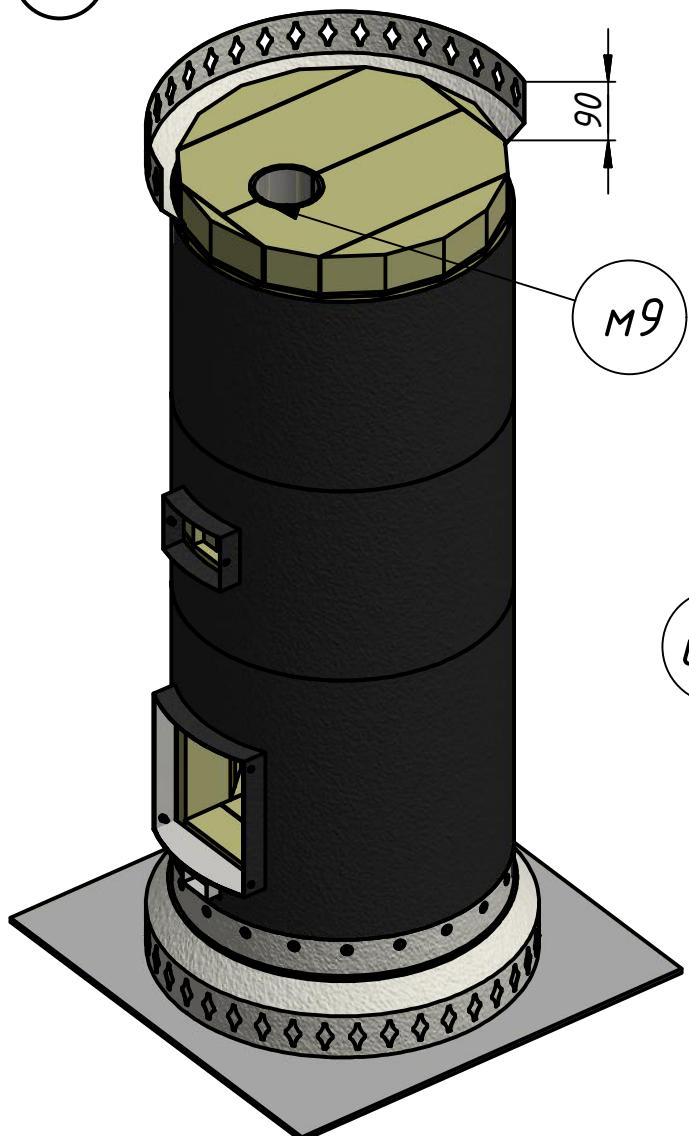
Угловой зазор между шамотом и деталью м5 проложить обрезками супервул и замазать раствором заподлицо с верхом шамота.
