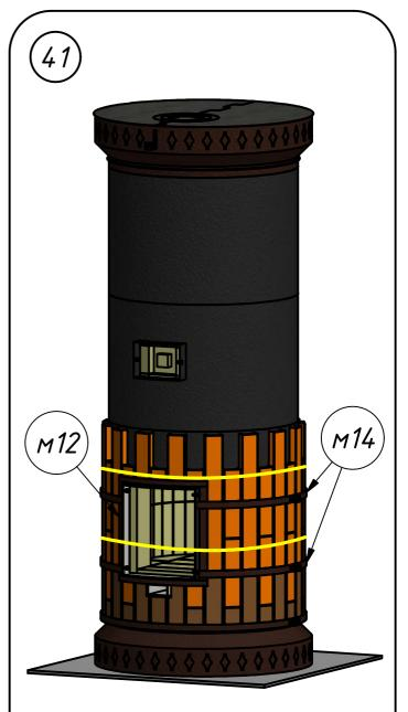
По мере сборки, эластичные жгуты необходимо передвигать вверх для установки следующего ряда плиток облицовки, предварительно зафиксировав предыдущий ряд при помощи хомутов.
