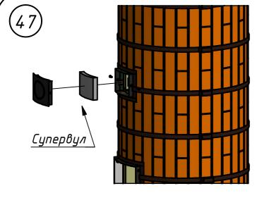
После сборки облицовки внутрь тоннеля прочистной дверки плотно вставить вырезанный с припуском прямоугольник из супервула, после чего устанавить заглушку чистки и закрепить ее болтами к1 – 2 шт.
